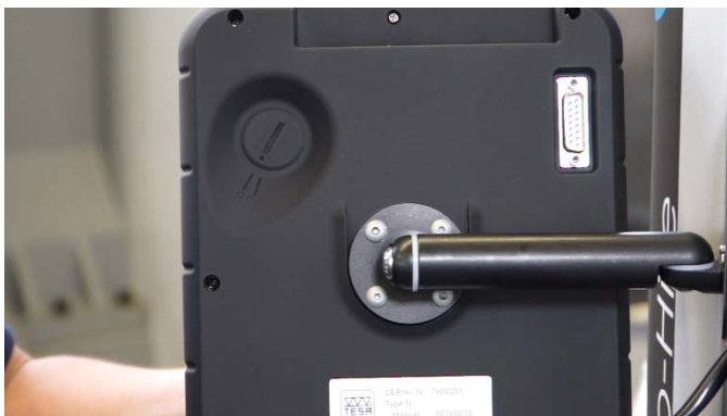
22 螺钉将固定控制面板到臂支架上.
