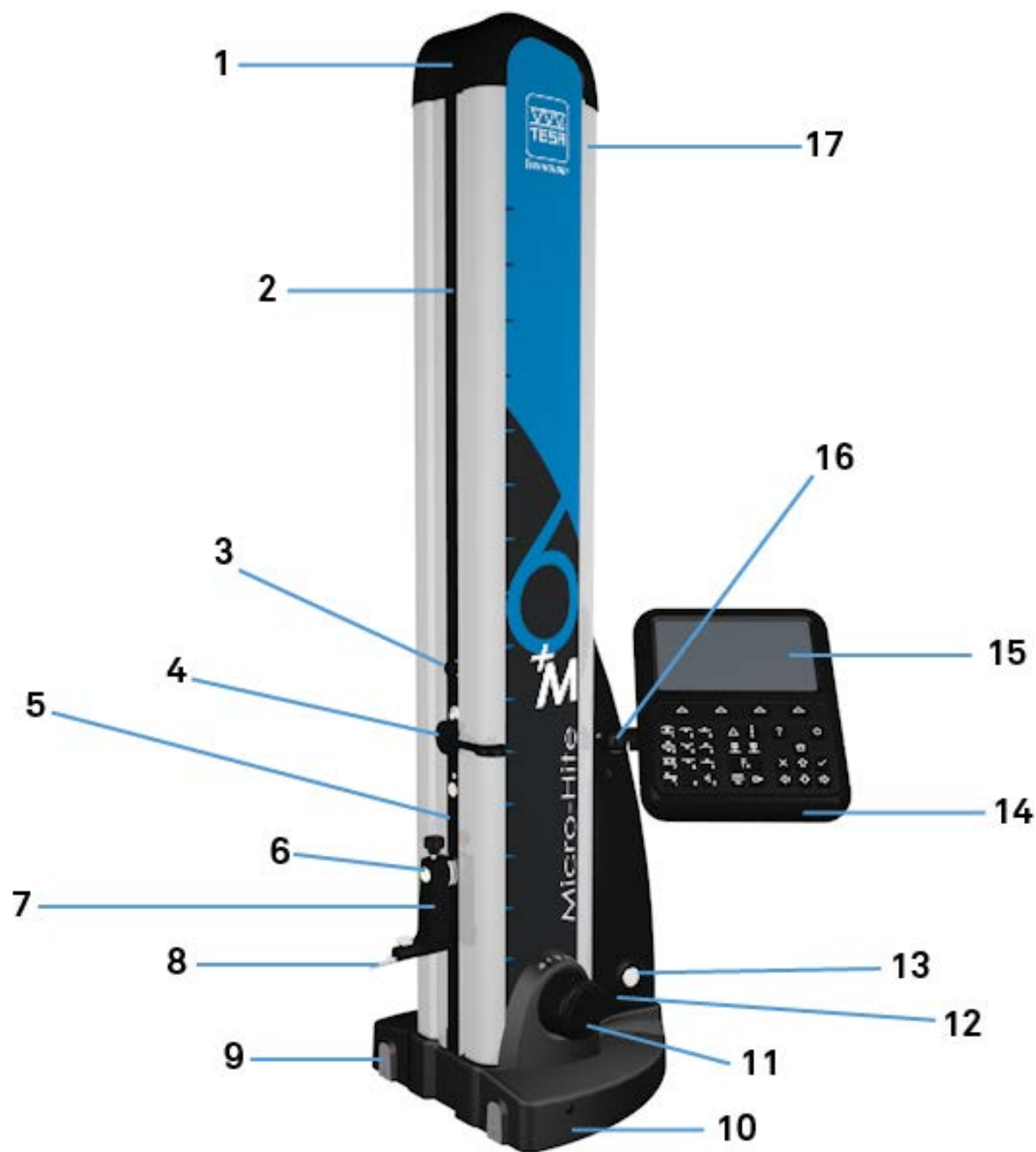
TESA MICRO-HITE+M 基本组成部件图
